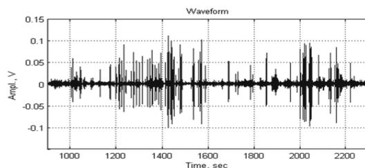
Рис. 1. Волновая форма геоакустических сигналов, зарегистрированных гидрофонной станцией 12.08.2007 г.
