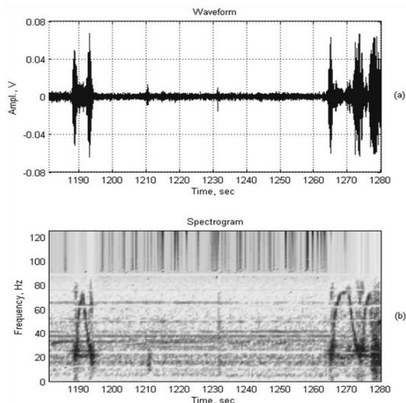
Рис.2. Волновая форма (a) и спектрограмма (b) гидроакустической записи МЗ.
