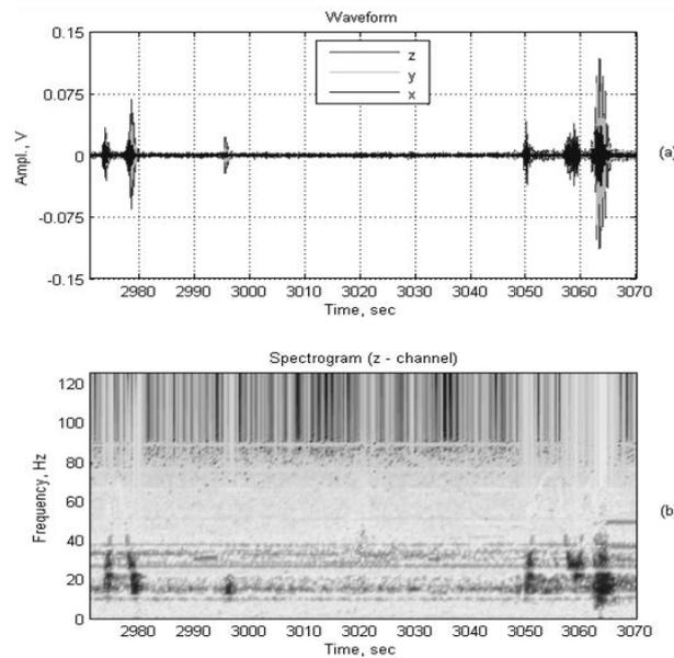
Рис.3. Волновая форма (а) и спектрограмма (b) сейсмоакустической записи МЗ.
