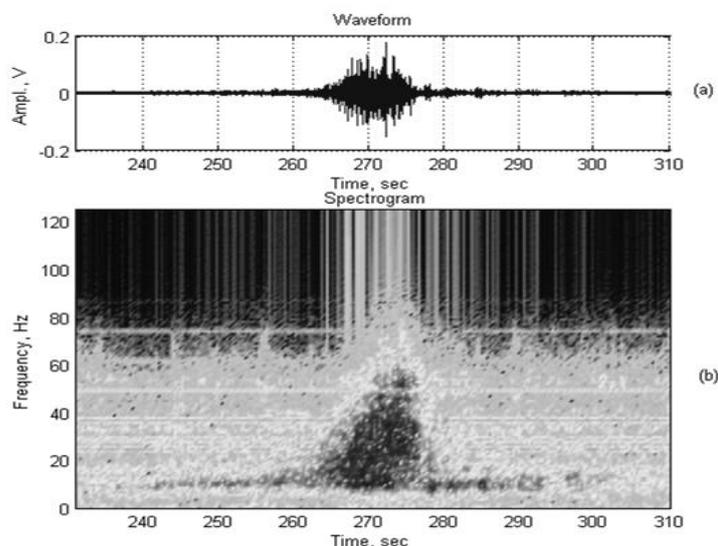
Рис.6. Волновая форма (а) и спектрограмма (б) упругого отклика активных пород.
