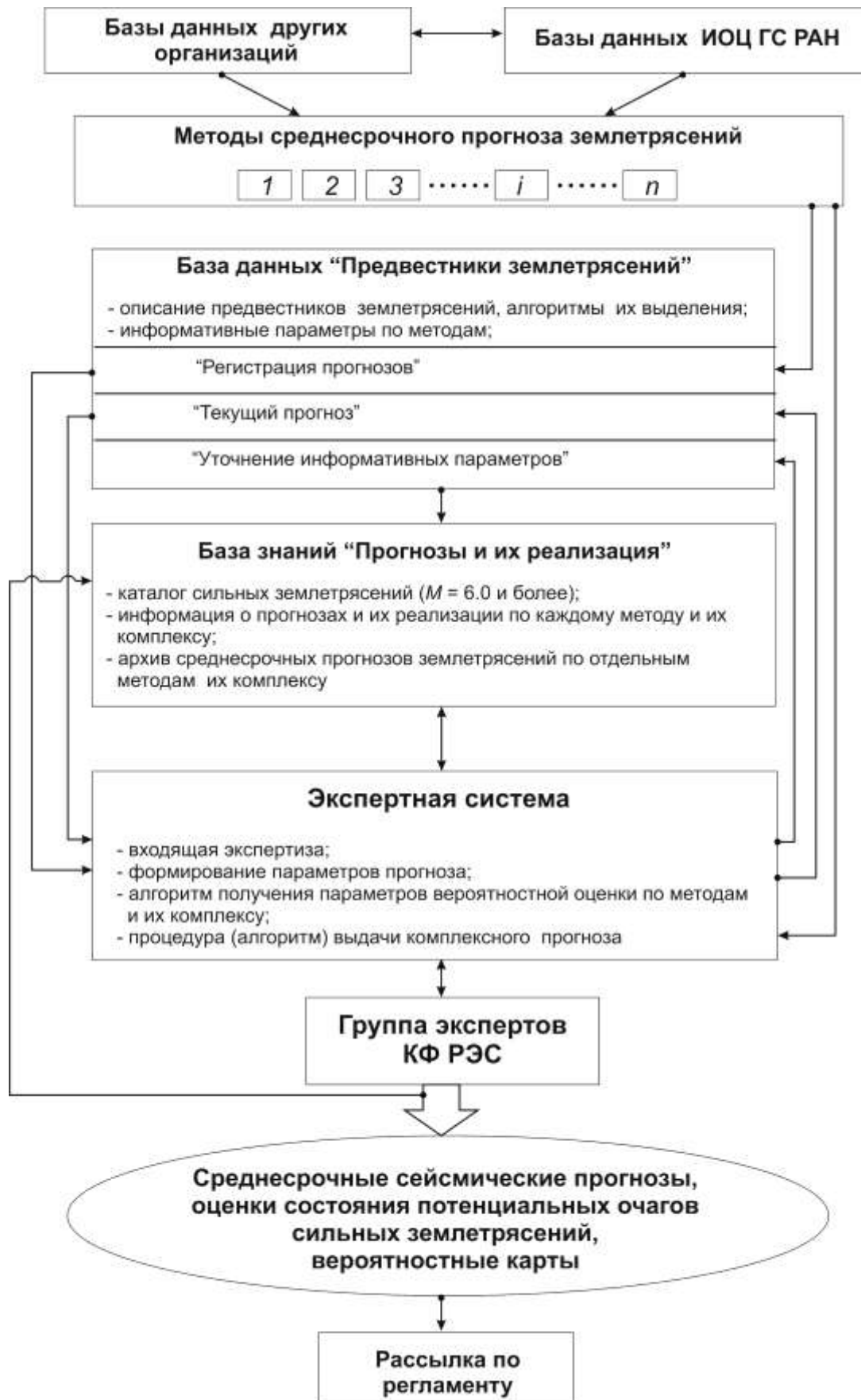
Рисунок 1 – Блок схема функционирования технологий среднесрочного прогноза сильных землетрясений (на примере Камчатского региона)
