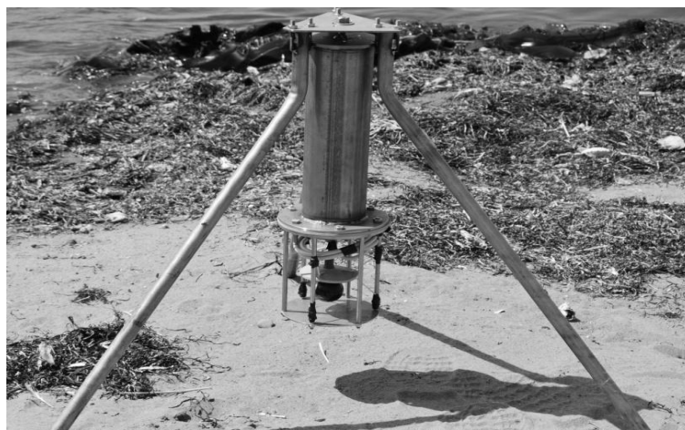
Рис. 1. Одноканальная автономная гидрофонная сейсмостанция
