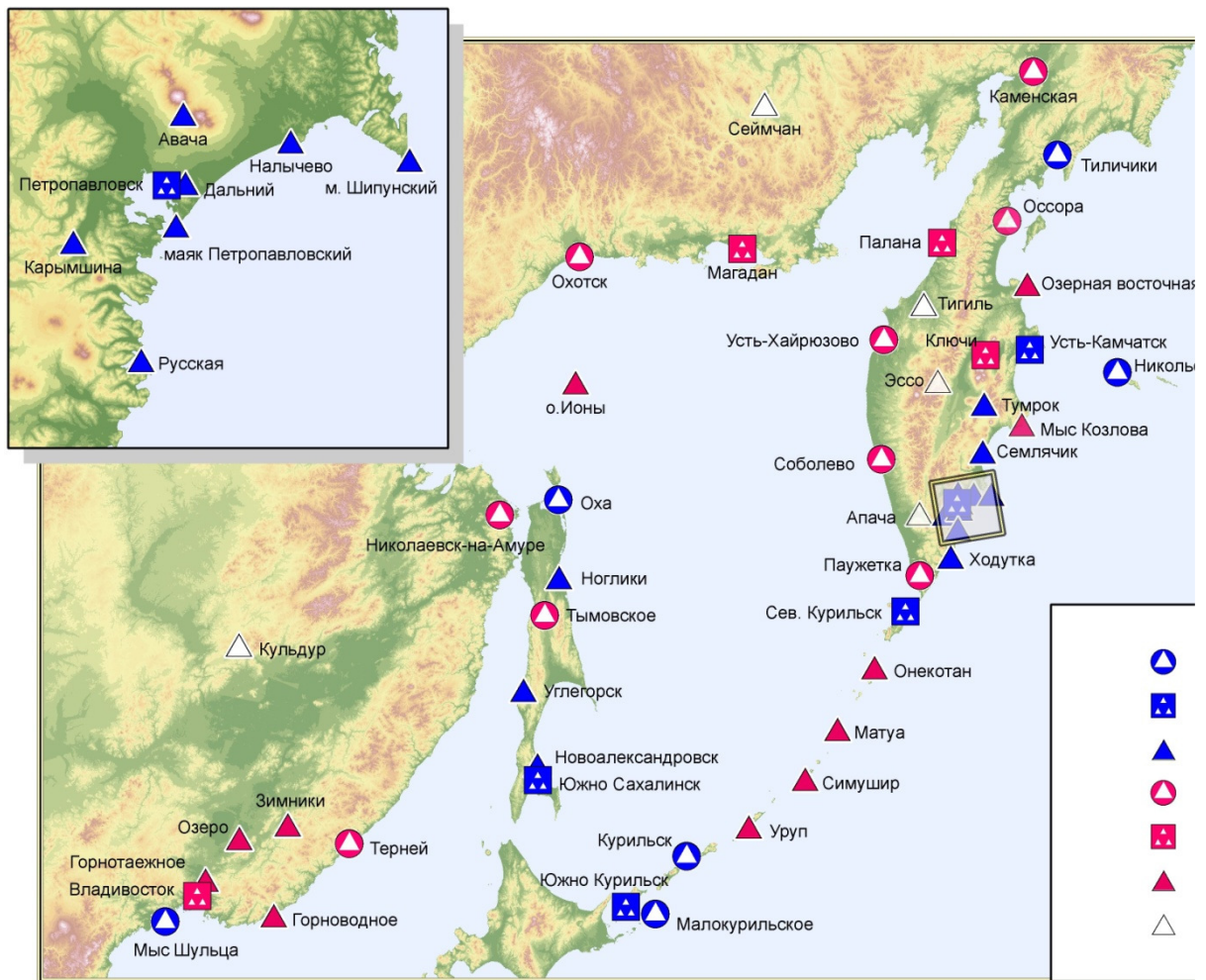
Рис. 1 Карта (проект) с сетью специализированных сейсмологических и GPS наблюдений для СПЦ Дальнего Востока России к 2015г. Специализированные сейсмические станции, созданные в 2006–2010: 1. ВЦС; 2. ОЦС; 3. ПР СД. Новые станции: 4. ВЦС; 5. ОЦС; 6. ПРСД; 7. другие станции
