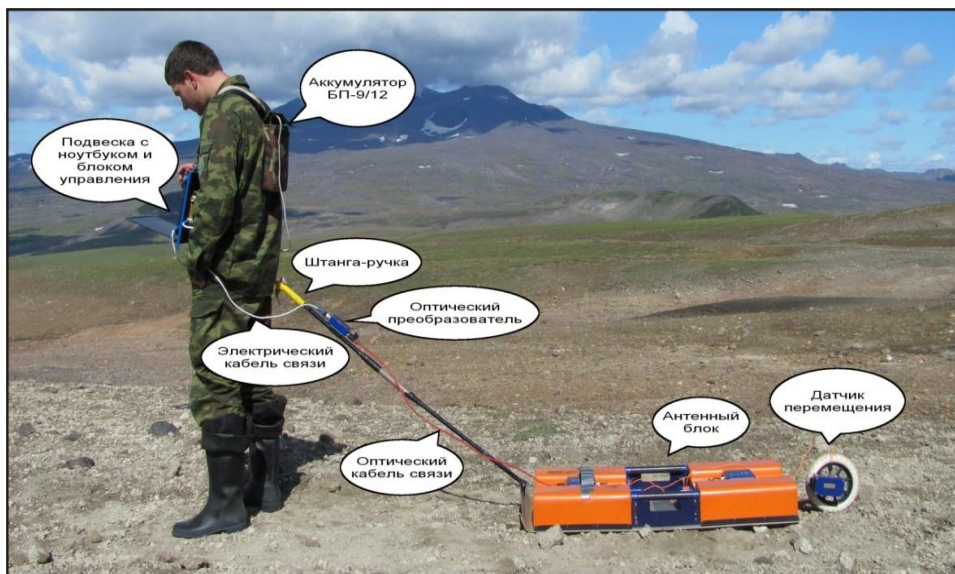
Рис. 2. Состав прибора георадар «ОКО-250». Фото Павловой В.Ю.
