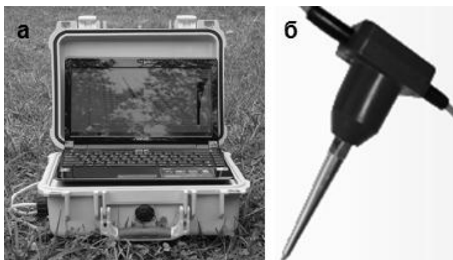
Рис.1. а – сейсморазведочная станция «ЭЛЛИСС-3»; б – сеймоприемник GS-20DX.
