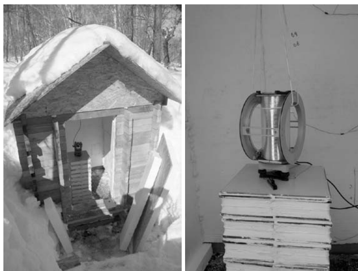
Рис.4. Установка векторного магнитометра POS-4 на ГФО "Паратунка". Слева — павильон POS-4 с DI-магнитометром Mag-01 при измерении склонения и наклонения, справа — датчик POS-4 на постаменте из стеклоблоков, на верхней части соленоида ортогонально расположены два точных уровня, на постаменте — контрольный уровень.
