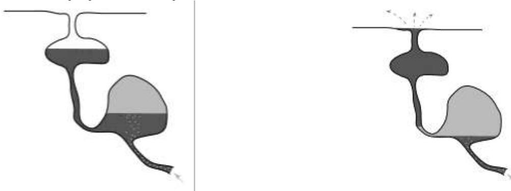
Рис.3 Возможная питающая система гейзера с камерой, где скапливается водяной пар, и расширением канала. Слева: стадия наполнения гейзера; справа: начало извержения, когда пар проник в канал и вода достигла поверхности.
