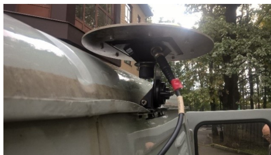
Рис. 3. Созданная подвижная система регистрации ГНСС: а) мобильный автономный вариант, б) антенна ГНСС, установленная на автомобиле
