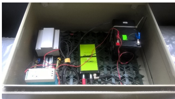
Рис. 3. Созданная подвижная система регистрации ГНСС: а) мобильный автономный вариант, б) антенна ГНСС, установленная на автомобиле
