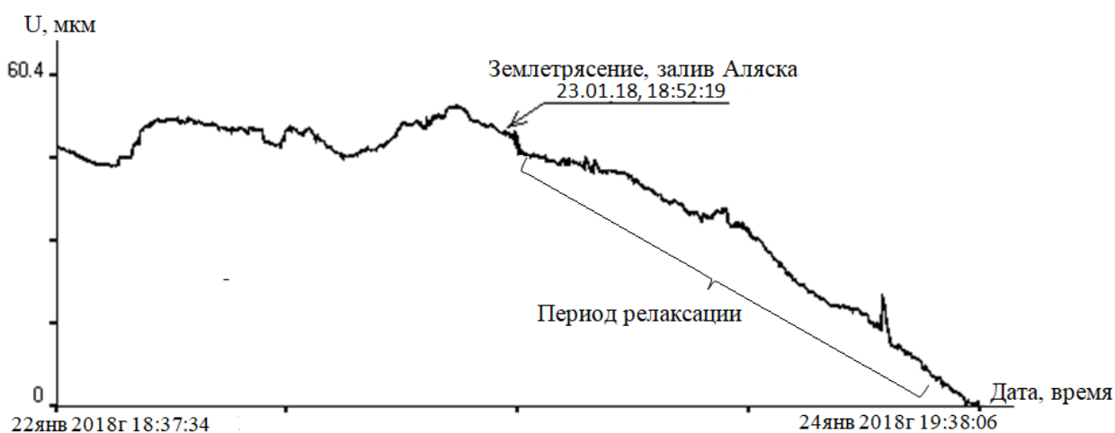
Рис. 4. Изменение деформаций массива горных пород месторождения «Антей» за период с 22 по 24 января 2018 г.
