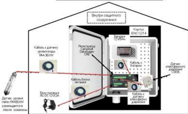
**Сентябрь 2017 г.** – Новый этап модернизации оборудования. В рамках Научно-технического соглашения с Геологической службой Израиля в скв. Ю3-5 было установлено оборудования в составе регистратора данных CR6 и барометра CS106 (PTB110) Campbell Scientific, Inc. (США); датчика давления воды PAA 36XW Keller (Швейцария); регистрация давления воды проводилась с частотой 10 и 40 Гц.
