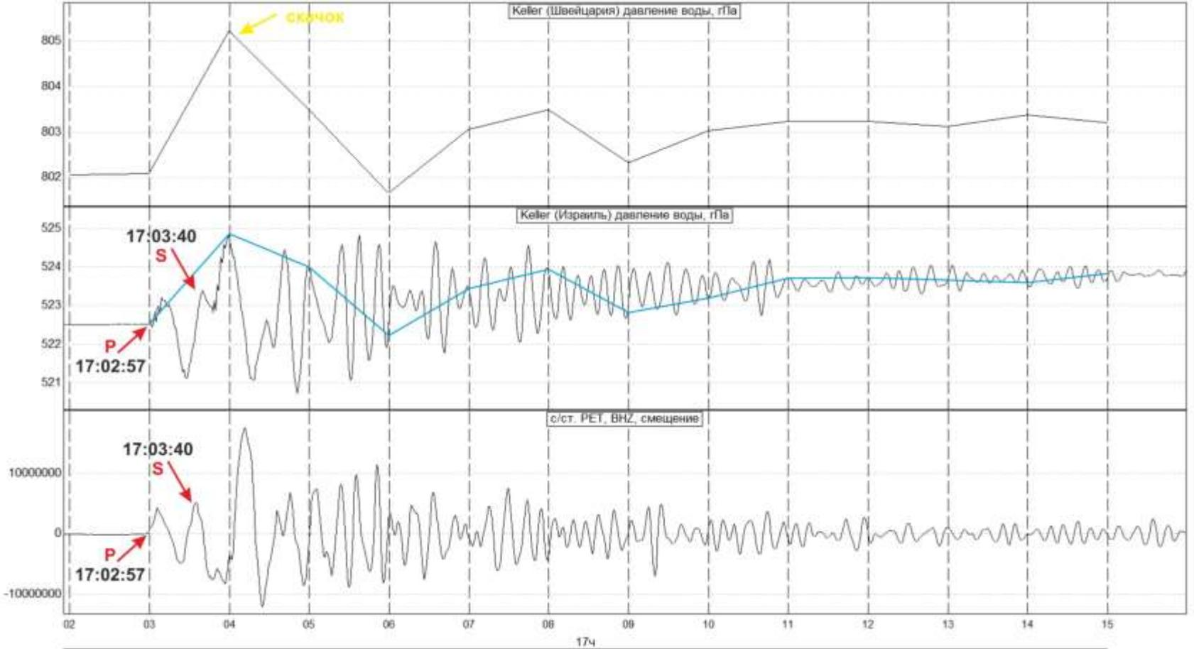
По 1-мин измерениям наблюдался скачок повышения давления воды с амплитудой  $\Delta h = 3.2$  см в течение 1-мин интервала времени, включающего вступление сейсмических волн на с/ст. PET. Полученная оценка объемной косейсмической деформации  $D_1 \approx -20 \cdot 10^{-9}$  значительно превышает теоретическую оценку  $D_2 = -2.5 \cdot 10^{-9}$  по [Okada, 1985], но согласуется по характеру деформации (сжатие).
