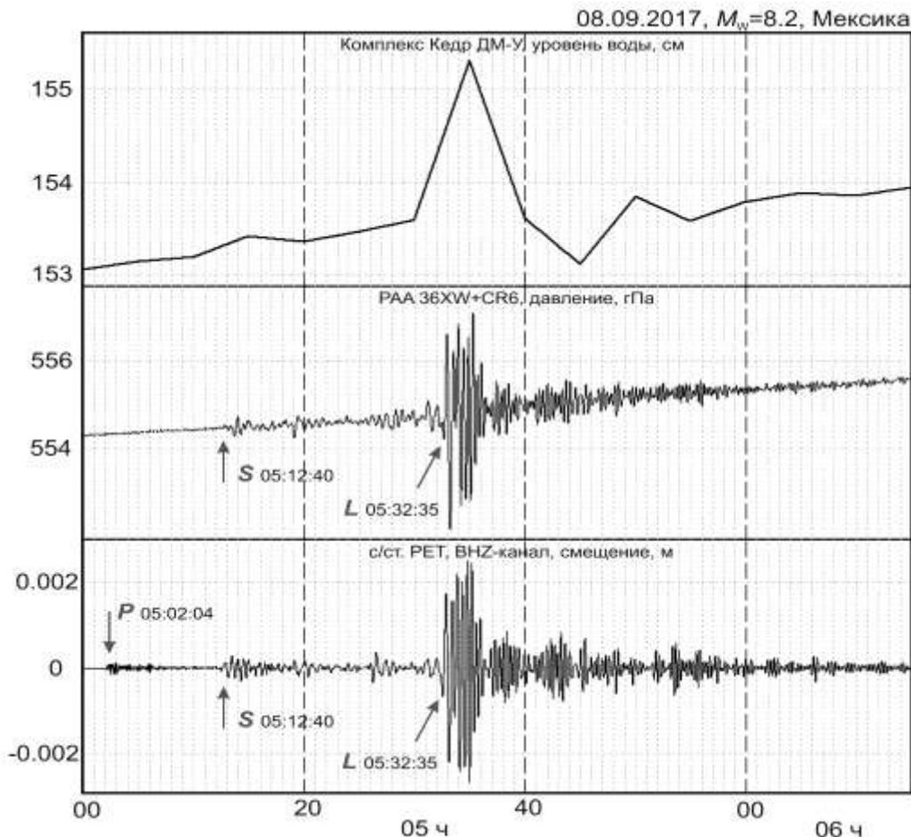
Вариации уровня воды с периодичностью измерений 5 мин (Кедр ДМ) и давления подземных вод на глубине 5.6 м с частотой регистрации 10 Гц (датчик РАА 36XW) в скв. ЮЗ-5 при землетрясении 9 сентября 2017 г.,  $M_w = 8.2$ , Мексика в сопоставлении с записью смещений на канале BHZ, с/ст. PET, датчик STS-1, 20 Гц.
