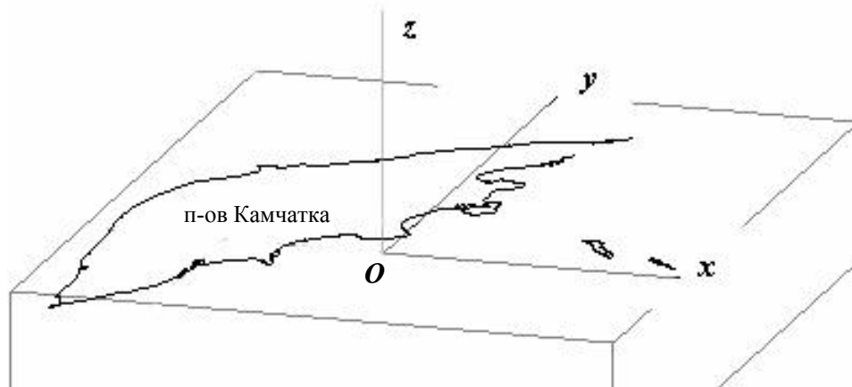
Рис. 1. Ориентация координатных осей и положение начала декартовой системы координат относительно береговой линии полуострова Камчатка. Плоскость Oxy является касательной к поверхности сферической Земли в точке \varphi = 53.196^\circ N , \lambda = 162^\circ E .
