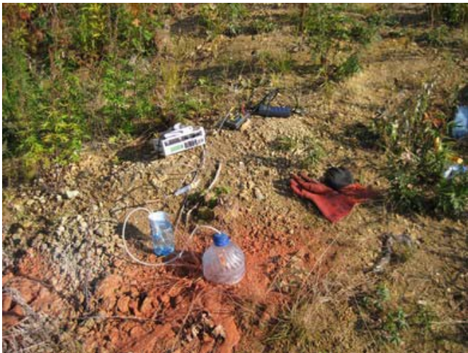
Рис. 2.3. Долина гейзеров. Отбор пробы воздуха и анализ концентрации водорода на новой термальной площадке
