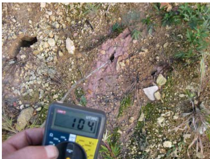
Рис. 2.6. Пример определения температуры на новой термальной площадке
