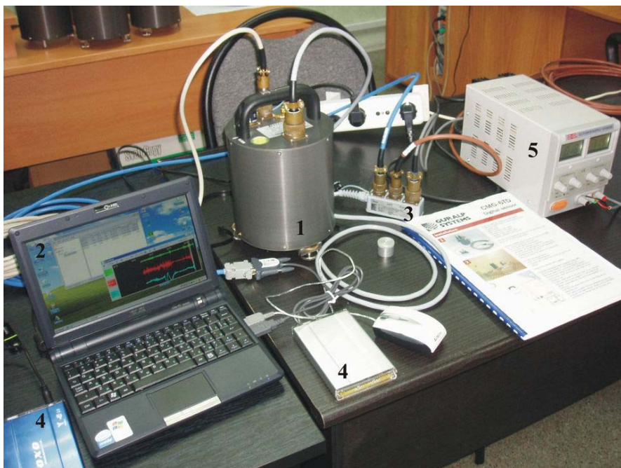
Рис.1.1 Лабораторные испытания сейсмометров CMG-6TD.
