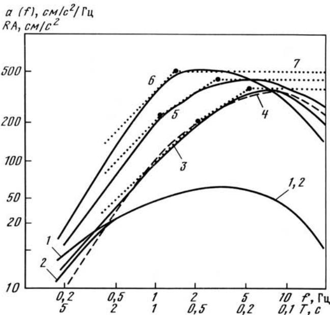
Рис. 4. Спектры Фурье ускорения  $a(f)$  и спектры реакции ускорения  $RA$  для типичных сильнейших толчков
