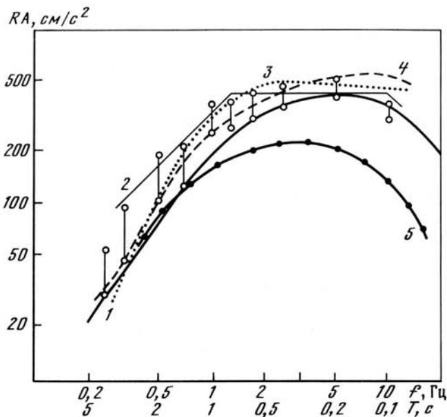
Рис. 5. Сопоставление спектров реакции ускорения для среднего грунта ( $M = 8$  и  $r = 85$  км)
