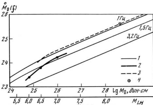
Рис. 2. Зависимость уровня очагового спектра  $\dot{M}_0(f)$  от сейсмического момента  $M_0$  и магнитуды  $M_{LH}$
